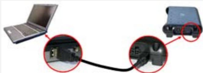
1. Koble sentralenheten til datamaskinen med en USB-kabel (A til mini B).
